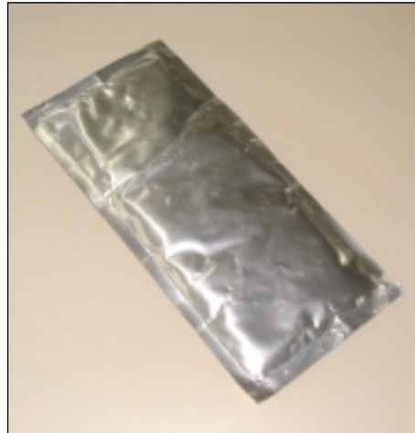
18 Makroverkapselung durch Einschweißen in Folie (Quelle: Climator, Schweden).
