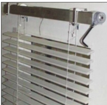
32 Funktionsmuster zur Integration von PCM in Sonnenschutzsysteme (Quelle: ZAE Bayern).
